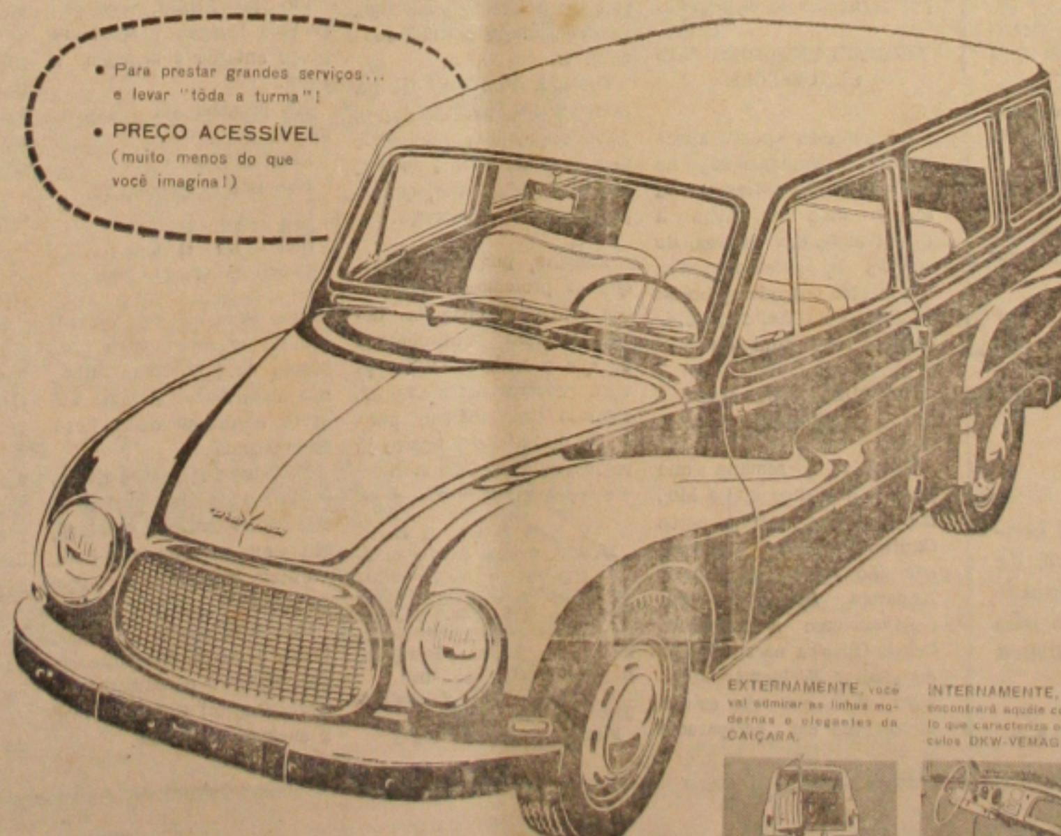
As qualidades técnicas são as mesmas que consagraram os veículos da linha DKW-VEMAG: tração dianteira, proporcionando excepcional estabilidade. Motor de dois tempos — econômico, potente, de fácil lubrificação e manutenção. Chassi ultra-reforçado, com todas as peças vitais colocadas a salvo das saliências do terreno.
